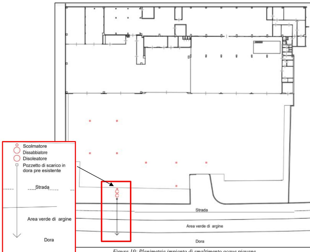
Figura 10: Planimetria impianto di smaltimento acque piovane
